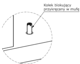
rys. 5 – kołek blokujący zamek
